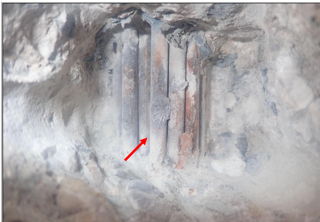
Foto 7: Detail sondy P7, předpínací výztuž NK, poloha viz Tabulka 3. Na předpínací výztuži nebyla nalezena koroze. Kanálek zcela vyplněn injektážní směsí. Krytí předpínací výztuže cca 53 mm.
